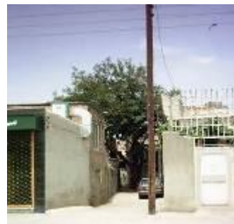
شکل ۹ - کاشت درخت در مقابل خروجی بلوک های مسکونی موجب ایجاد مانع برای خروج سریع و ایمن از درون ساختمان می شود
